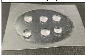
樹脂ナノスパイク上の水滴 Water on polymer
